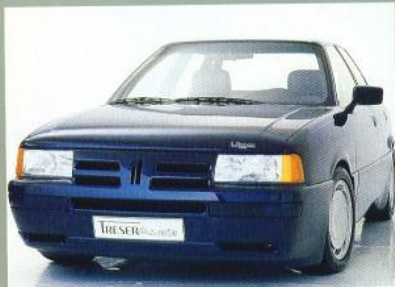
Version Audi 80 - mit Spezialabdeckungen für Blinker-Scheinwerferöffnungen
